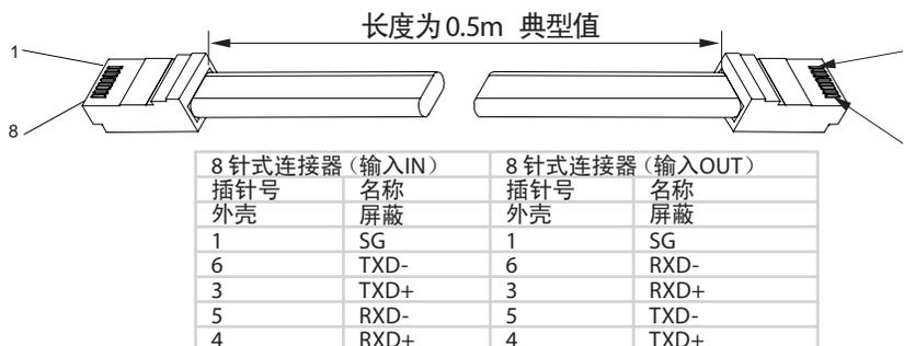
图 7-6: 带有 RJ-45 屏蔽连接器的串行环线 (型号: GEN/RJ45)
