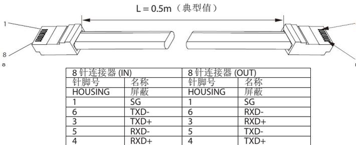
图 7-8: 带有 RJ-45 屏蔽式连接器的串行连接电缆（部件编号：Z-RJ45）
