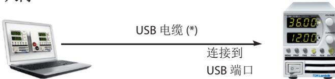
以下步骤将帮助您快速掌握如何将支持 USB 功能的电源连接到通用串行总线 (USB):
